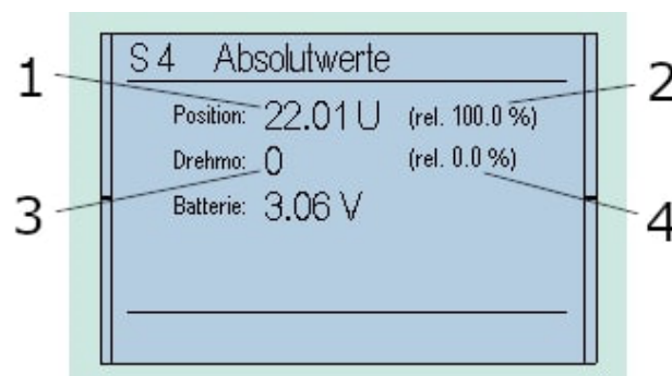
Bild 41: 1... Absolutwert der Positionseinheit, 2... Relativwert der Positionseinheit, 3 und 4... Absolut- und Relativwert der Drehmomenteinheit (wird im Werk kalibriert)
